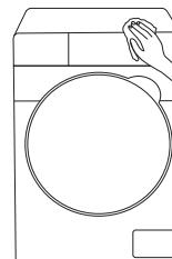
切勿用水沖洗外殼，以免造成洗衣機部件的損壞。
