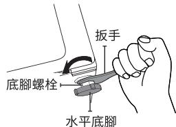
2. 調整水平底腳直到所需的高度。向左旋轉為調高底腳，向右旋轉則為調低底腳。
