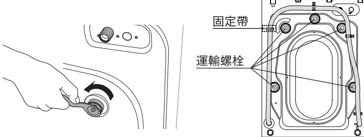
2. 抓住螺栓帽將螺栓從孔位拉出。重複相同步驟拆除所有運輸螺栓。
