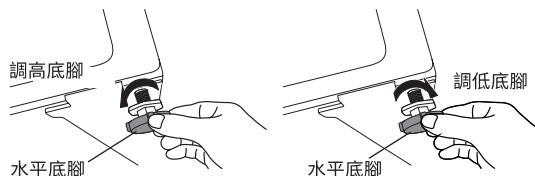
3. 用扳手將底腳螺栓旋緊。
