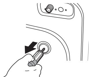
3. 用附件袋中的運輸螺栓孔蓋將孔塞住。
