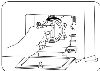
4.清洗過濾蓋上的殘渣和污漬，並確保排水泵內部沒有被阻塞。
