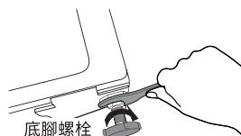
4. 檢測水平底腳是否水平，四個底腳相對地面沒有晃動，洗衣機才是水平的。按照以下步驟：
