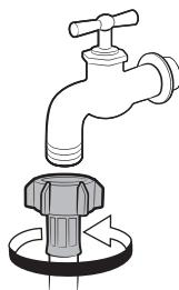
如果您使用的是螺旋式水龍頭，請使用所提供的螺旋式適配器與水龍頭連接，如圖所示。
